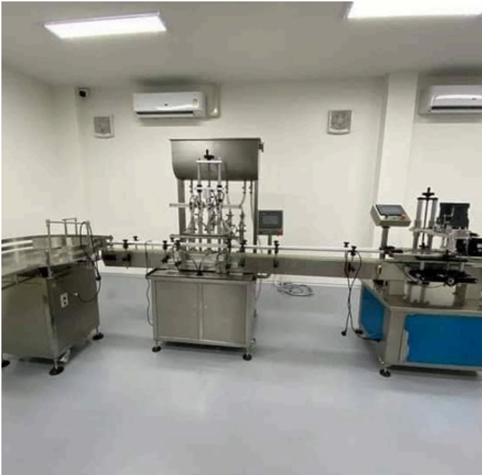
สายการผลิตบรรจุของเหลวและปิดฝาอัตโนมัติ (Automatic Liquid Filling and Capping Production Line)
